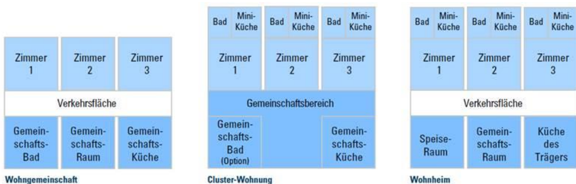
Abb. 2: Schematische Darstellung von Grundrisstypologien im Vergleich
